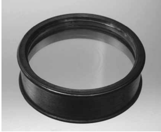
Figura 8 - Dispositivo para observar os anéis de Newton por compressão (FIS.1330).
